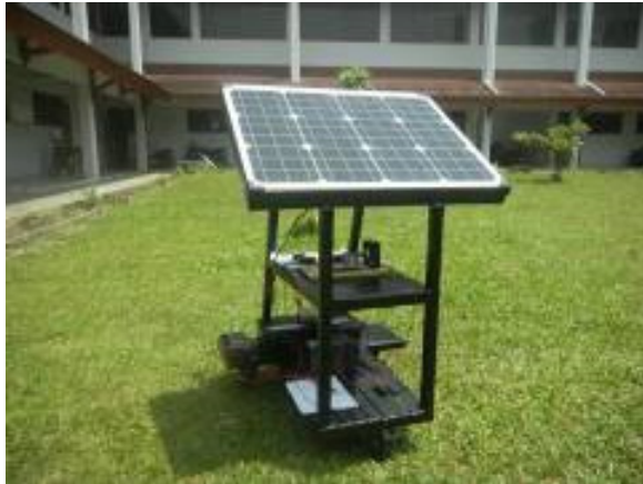
Gambar 8. Foto dokumentasi pengujian pengisian baterai SLA oleh panel surya
