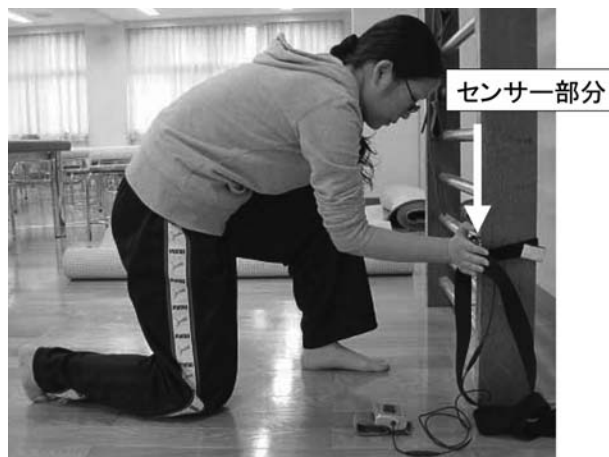
図2. 徒手最大圧迫力の測定方法
