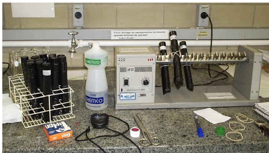
Figura 29: Sistema composto de tubos e agitador rotativo usado na avaliação da liberação de oleoresina de micropartículas coacervadas.
