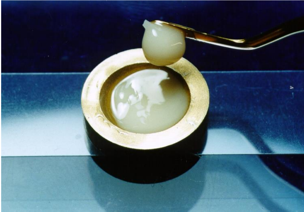
Figura 4. Compósito restaurador sendo inserido na matriz metálica posicionada sobre a tira de poliéster.
