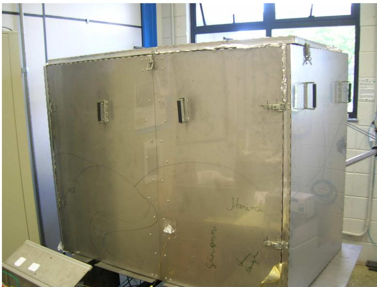
Fig. 1.18: Forno construído para o *baking* da câmara de MBE fotografado durante o procedimento.
