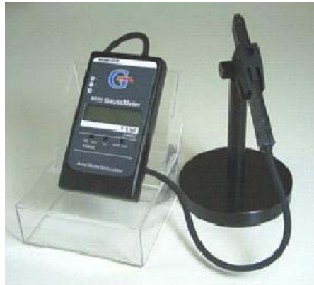
Figura 2.8 – Miligaussímetro com precisão de 0,1 miligauss [54].
