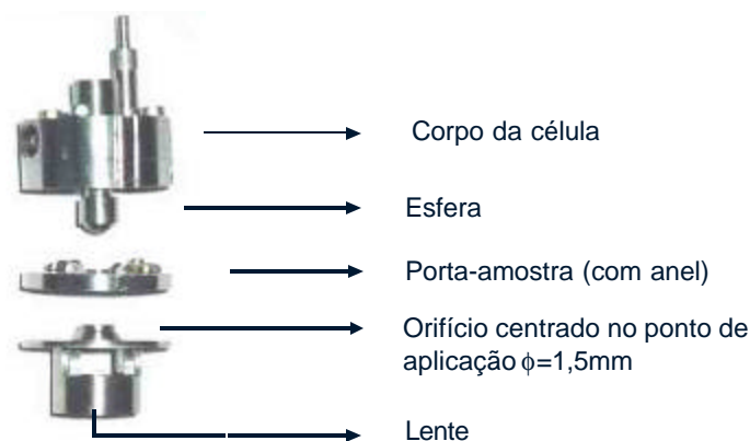
Figura 3.3: célula de pressão e adaptação para medidas ópticas e magneto-ópticas.
