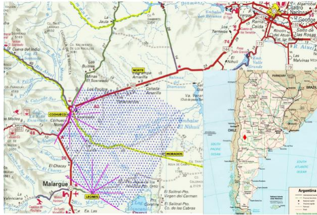
Figura 2.1: Região na Argentina coberta pelo array dos detectores do Observatório Pierre Auger. Os pontos azuis representam as posições ocupadas pelos tanques Cherenkov. As linhas violeta indicam os ângulos de observação da cada telescópio de fluorescência
