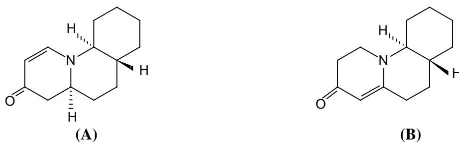
Figura 2.15 - Estrutura dos compostos 5 (A) e 7 (B), com o anel C saturado, citados na tabela 2.8.
