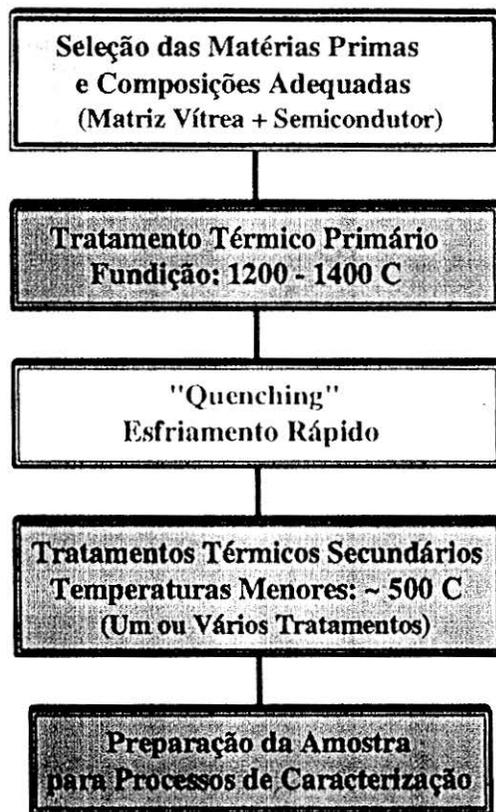
Figura II.1 - Esquema do Processo de Fabricação dos VDS.
