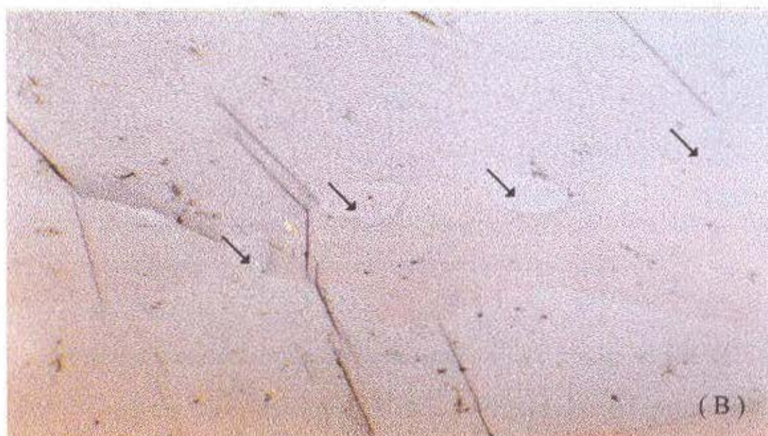
Figura 5.1- Análise metalográfica para a amostra LaNi sem tratamento térmico (A) e com tratamento térmico(B), onde as setas indicam a presença da segunda fase
