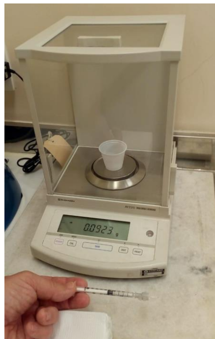
Figura 13. Aparato experimental para determinação do volume da gota obtida com uma seringa de insulina.
