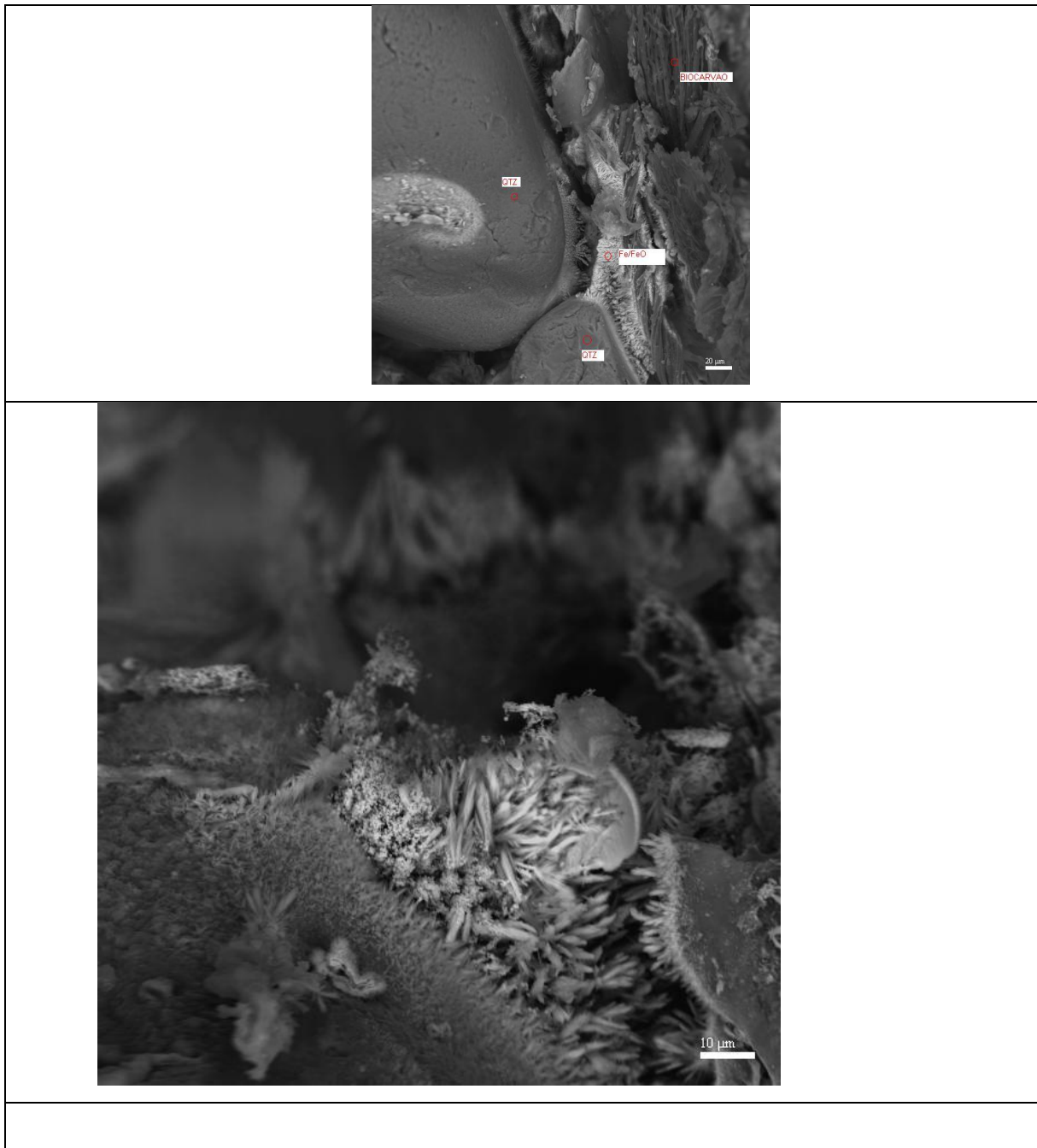
Figura 40 - Imagens de elétrons retroespalhados da base da coluna com BCCana+Fe mostrando estruturas vegetais preservadas e os desenvolvimentos dos óxidos de Fe precipitados após o tratamento da DAM e cristais de quartzo.
