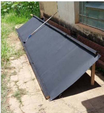
Figura 5-9 – Estrutura Coletor Solar.
