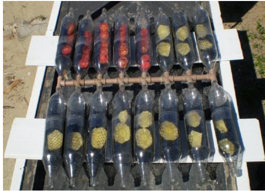
Figura 3-9. Secador solar natural de garrafas PET
