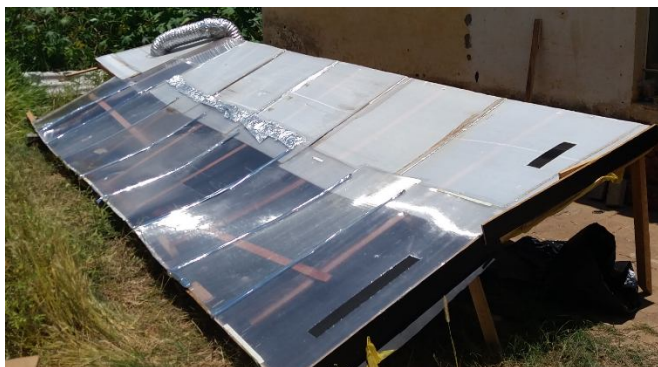
Figura 5-11 – Estrutura Coletor Solar.
