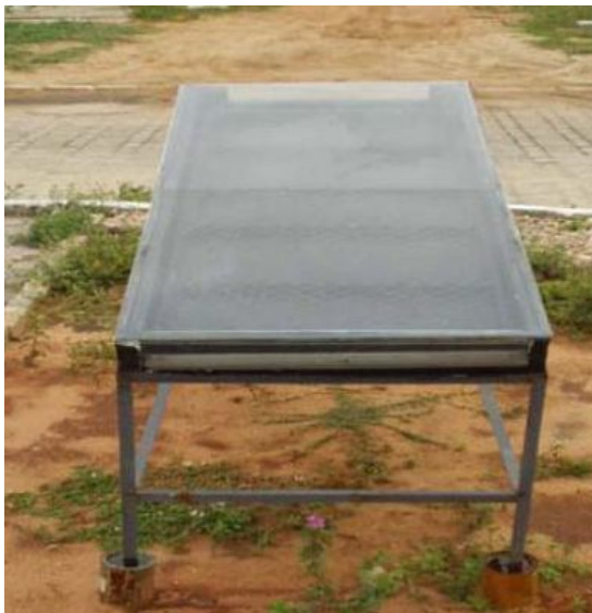
Figura 3-15. Secador solar de exposição direta.
