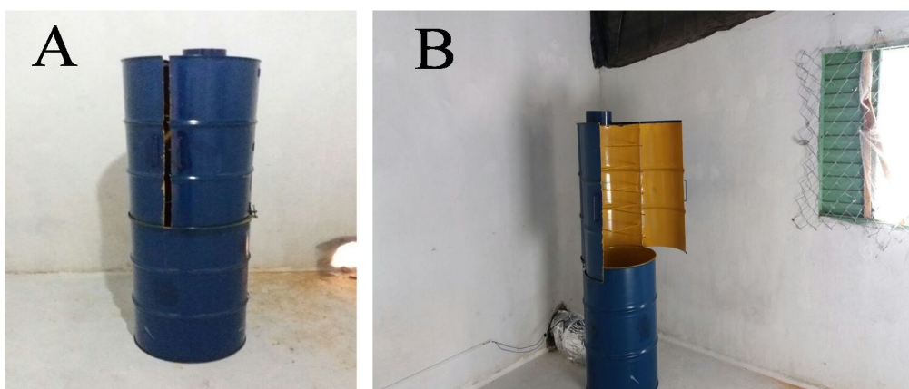
Figura 5-5. Fotos do secador solar montado. Tambores montados (A); Secador solar montado (B).
