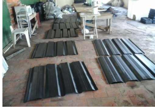
Figura 5-6. Placas do coletor pintadas
