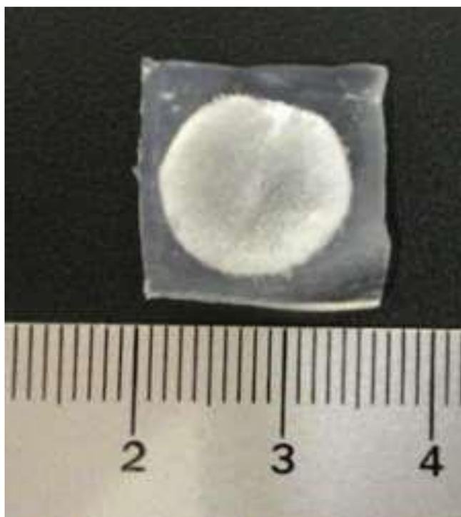
**Figura 3.** Dispositivo bilaminar de PVA-AgNPs/col-AH. A membrana de PVA (material transparente e quadrado) encontra-se abaixo do arcabouço de col-AH (material opaco em formato circular).
