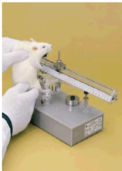
Figura 25. Analgesímetro Hugo Basile utilizado para o teste de pressão na pata.
