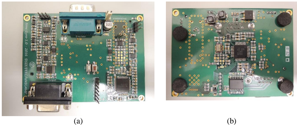
Figura 38. Versão final (PCB 4 camadas) da segunda versão do circuito eletrônico para IFOGs: (a) face superior e (b) face inferior.
