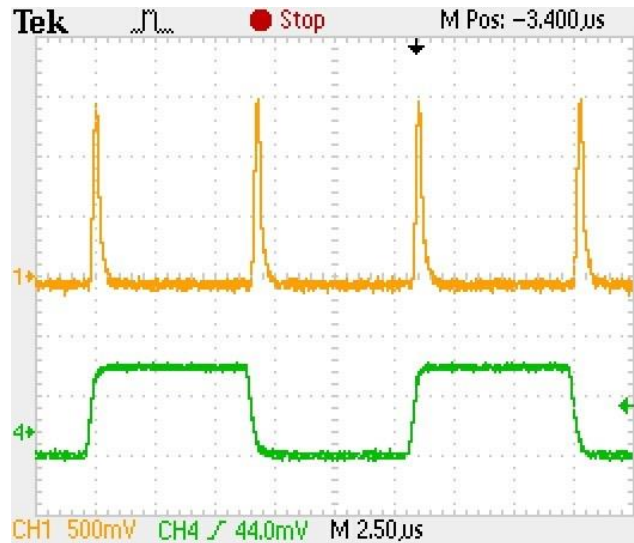
Figura 22. Sinal de modulação (verde) e sinal saída do amplificador de transimpedância (amarelo).
