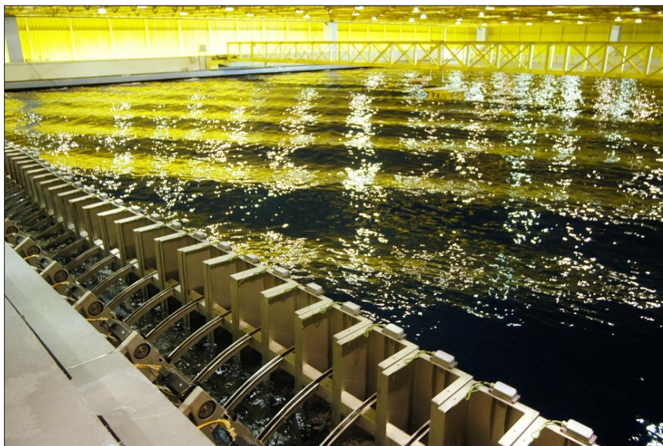
Figura 4.7 - O Tanque do LabOceano (UFRJ) e o Gerador de Ondas Multidirecionais
