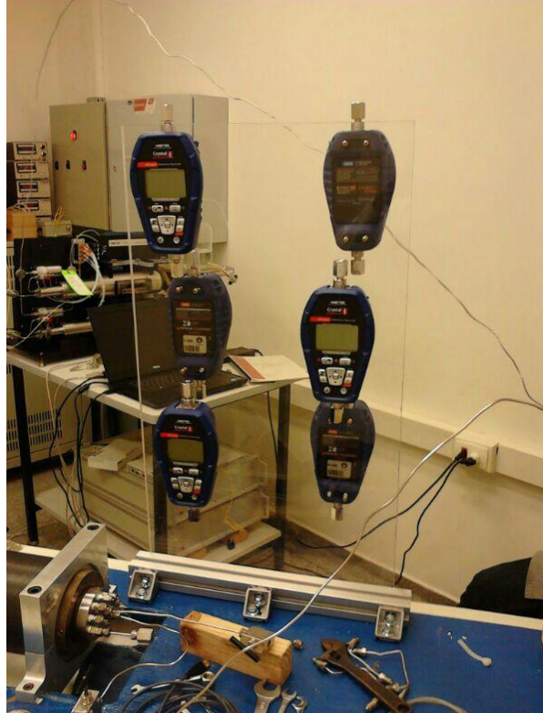
Figura 4.40. Aparato para fixação dos transdutores de pressão.
