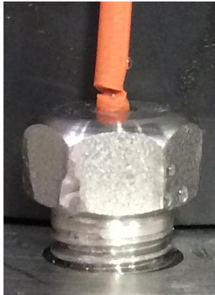
Figura 4.42. Linha de PEEK rompida.
