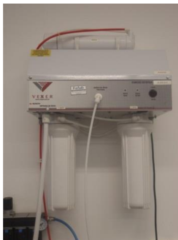
Figura 4.30. Equipamento de osmose inversa (Vexer, Brasil) para obtenção de água deionizada.
