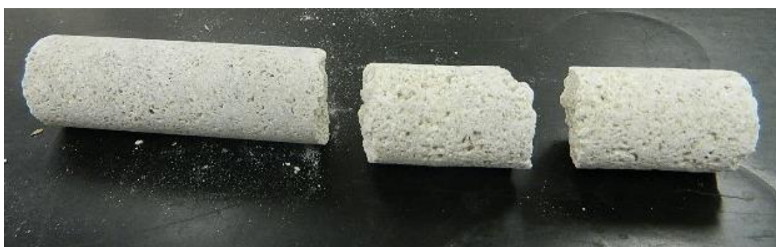
Figura 4.48. Amostra de coquina CoqB fraturada nos testes de comissionamento.
