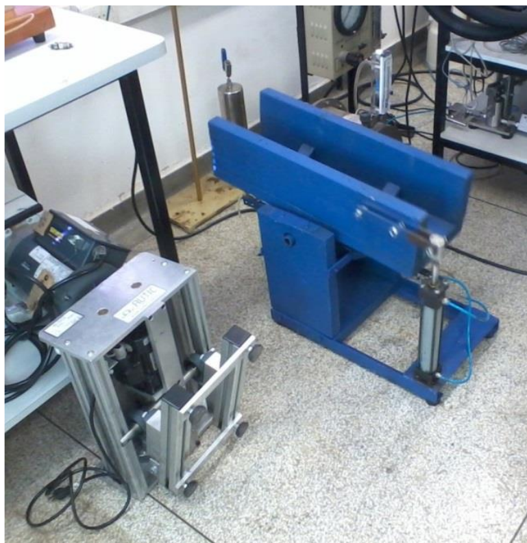
Figura 4.33. Equipamento pneumático para agitação das garrafas.
