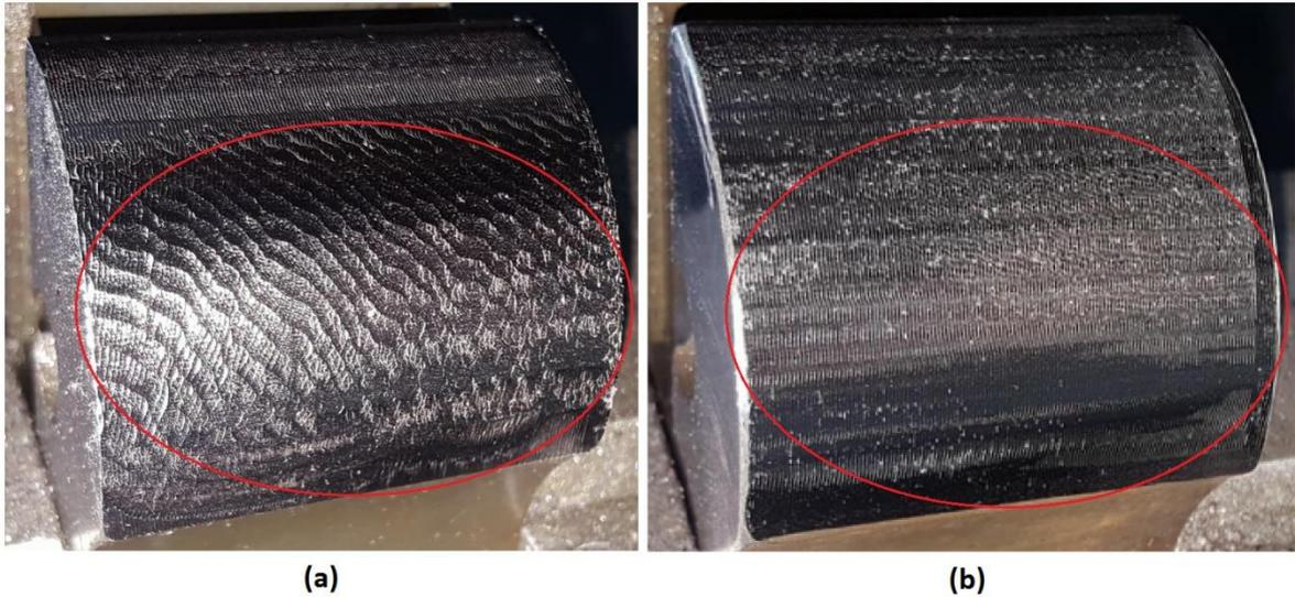
*Figura 4.12: Superfícies usinadas com (a) ferramenta maciça e (b) ferramenta com esferas de 5,9 mm na trajetória circular ascendente.*
