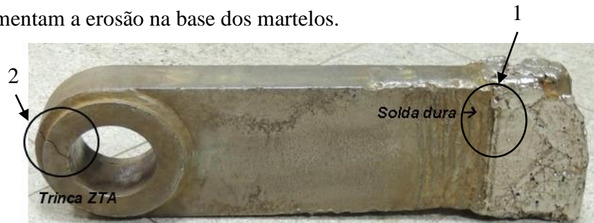
Figura 2.17: Ocorrência de trincas em trabalho, em martelos com regiões com cordões de solda: (1) ZTA na região do revestimento duro na base do martelo; (2) ZTA na região da solda de união anel/corpo do martelo. (EUTECTIC ® , 2014)
