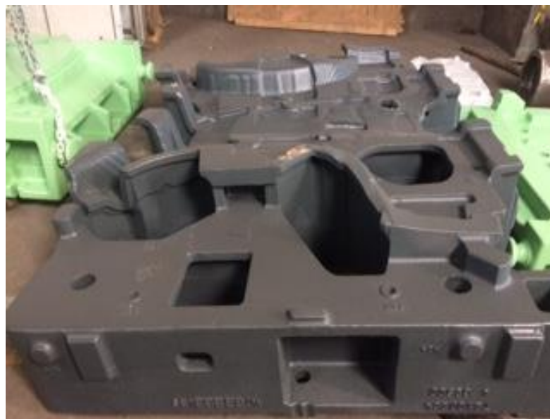
Figura 2.11: Peça fundida em FE 50007 de estrutura ferrita-perlita de 6000 Kg, fabricada na Empresa FEMAQ®. Foto do autor.
