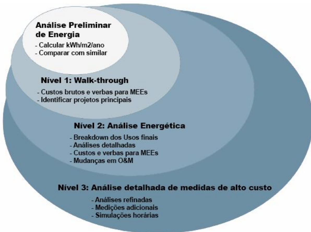
Figura 6: Níveis de Diagnóstico Energético, conforme padrão ASHRAE
