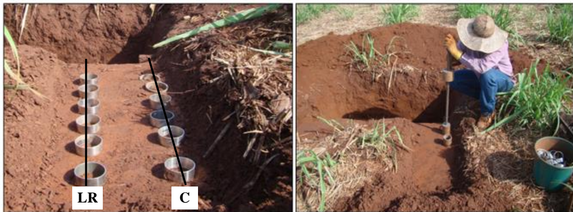
Figura 13. Coleta de amostras de solo indeformadas para avaliação da capacidade de suporte de carga no solo localizada no município de Nova Europa-SP, Brasil. LR = linha do rodado; C = canteiro.
