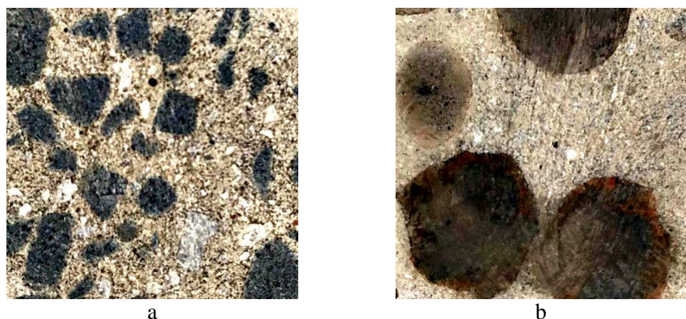
Figura 7. Exemplos de imagens da seção transversal de amostras de concreto produzidas com brita 0 (a) e com argila expandida (b) utilizadas para verificar a existência de vazios – resistência características de 28 MPa (B0) e de 26 MPa (AE).
