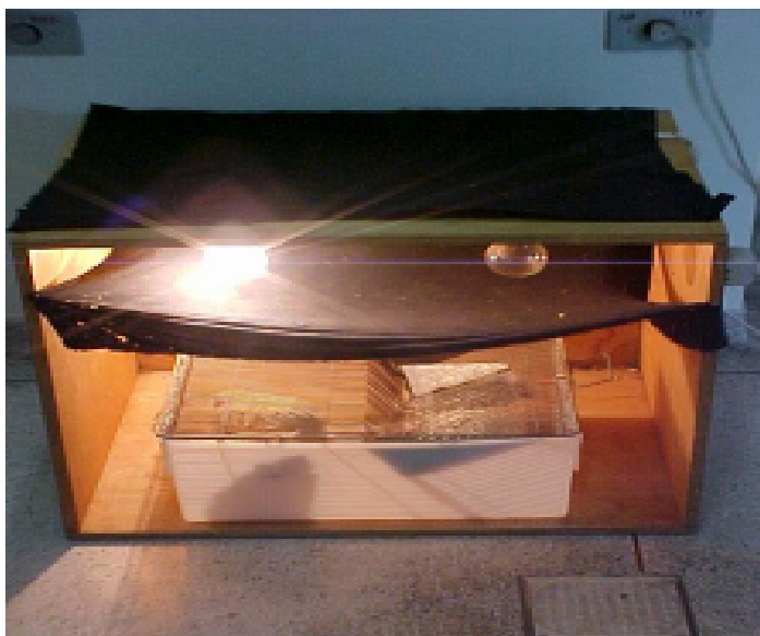
Figura 6. Caixa de luz para aquecimento dos animais.
