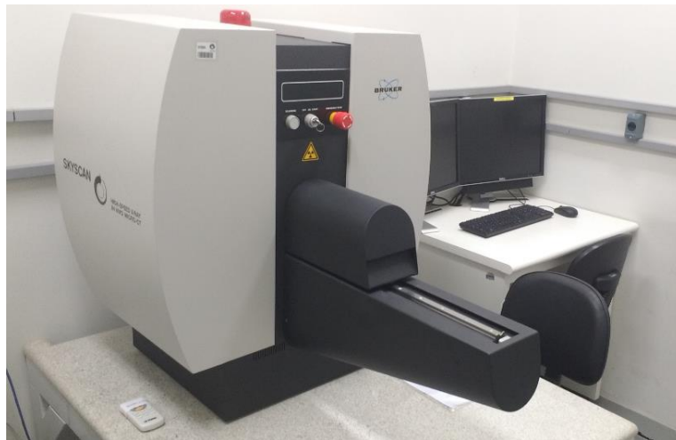
Figura 2: Aparelho de micro tomografia computadorizada (Skyscan 1178 - Bruker) utilizado para coleta de imagem e mensuração da massa ventricular dos corações infantis.
