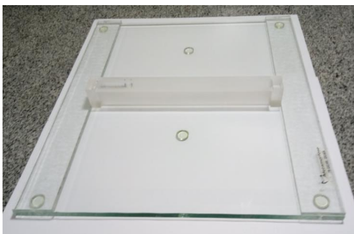
Figura 7 – Placa de vidro e extensor de acrílico empregados na preparação do bioadesivo.
