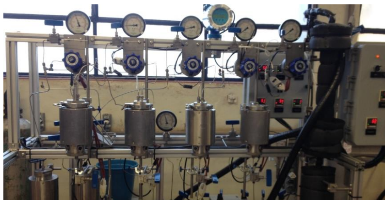
Figura 5 – Equipamento de extração e fracionamento com fluido supercrítico.
