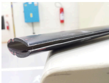
(a) TE gap ( h = 1.5\text{mm}, 3\text{mm} ).
