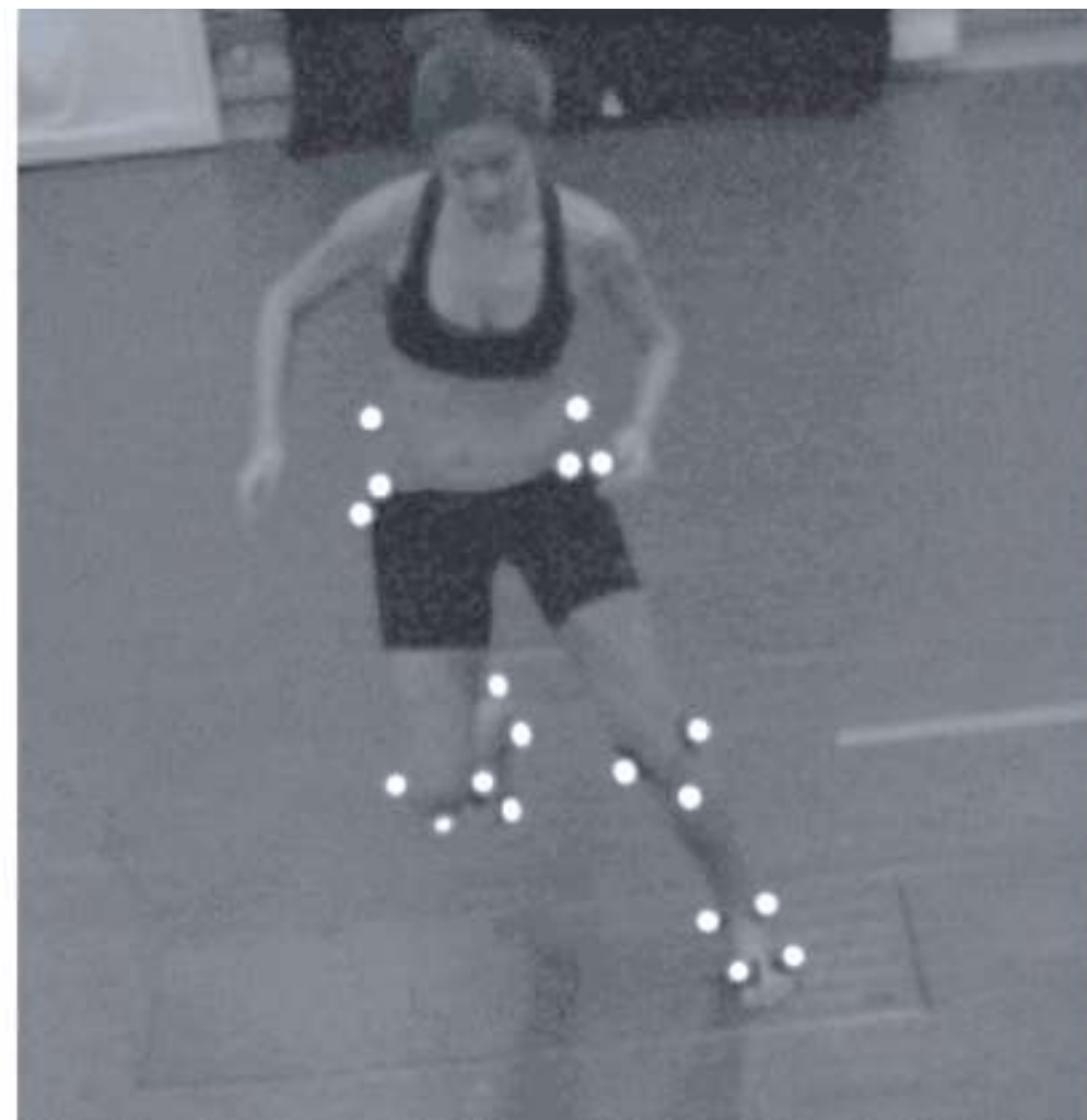
Figura 7. Demonstração da execução da mudança de direção sobre uma plataforma de força.
