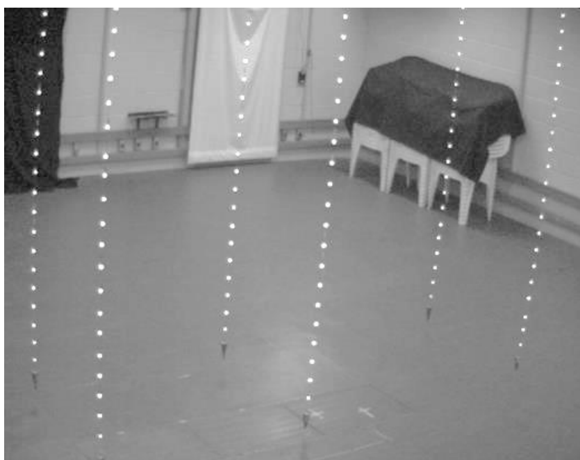
Figura 3. Objeto de calibração composto por 6 fios de prumo.
