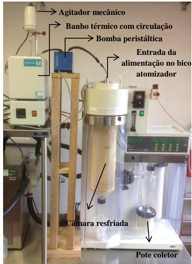
Figura 1. Esquema do equipamento de spray chilling para produção das micropartículas lipídicas contendo oleoresina de gengibre.
