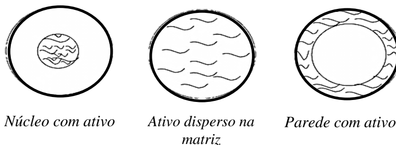
Figura 2.13. Esquema dos possíveis modelos estruturais das partículas contendo o ativo. (Fonte: WISSING; KAYSER; MUELLER (2004) adaptado de MÜHLEN; SCHWARZ; MEHNERT (1998)).
