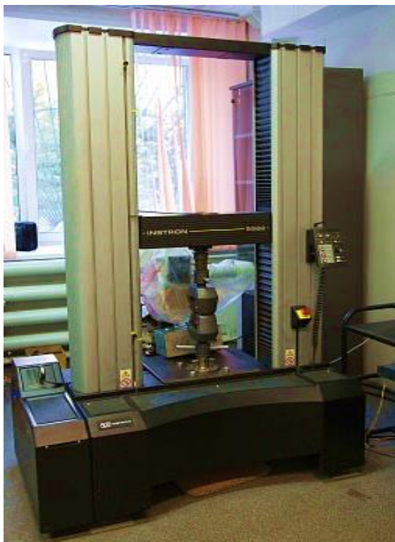
Figura 31 - Equipamento para ensaios de tração (Instron-5582).
