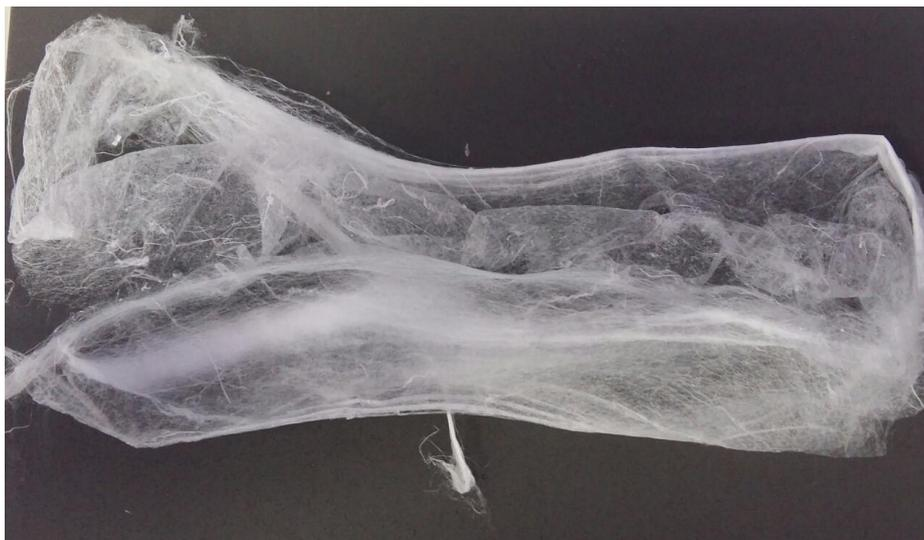
**Figura 7** – Aspecto macroscópico da membrana fibrosa obtida pelo processo de rotofiação.
