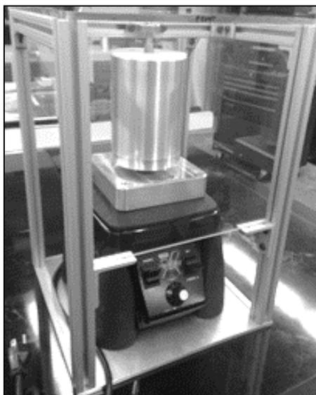
**Figura 6** – Equipamento de rotofiação utilizado no trabalho, disponível na Faculdade de Engenharia Mecânica – UNICAMP. Imagem cedida como cortesia pela Dra. Guinea Brasil Camargo Cardoso.
