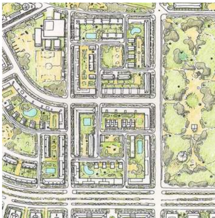
Figura 42: Esquema de edificios residenciales en esvástica, con plaza interior semi-pública diseñados para el PAU Carabanchel.
