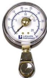
c) Dinamômetro Pinch Gauge
