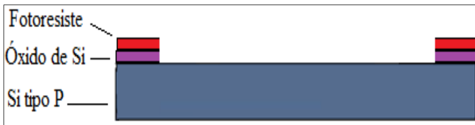
Figura 23 - Estrutura formada após a corrosão do óxido.
