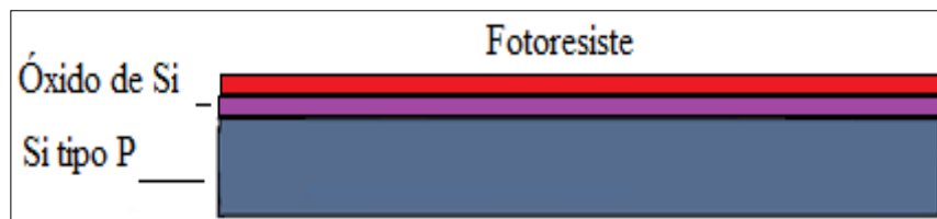
Figura 21 - Lâmina com uma camada de fotoresiste AZ 1518, após o pré-bake de 90° C por 1 minuto.
