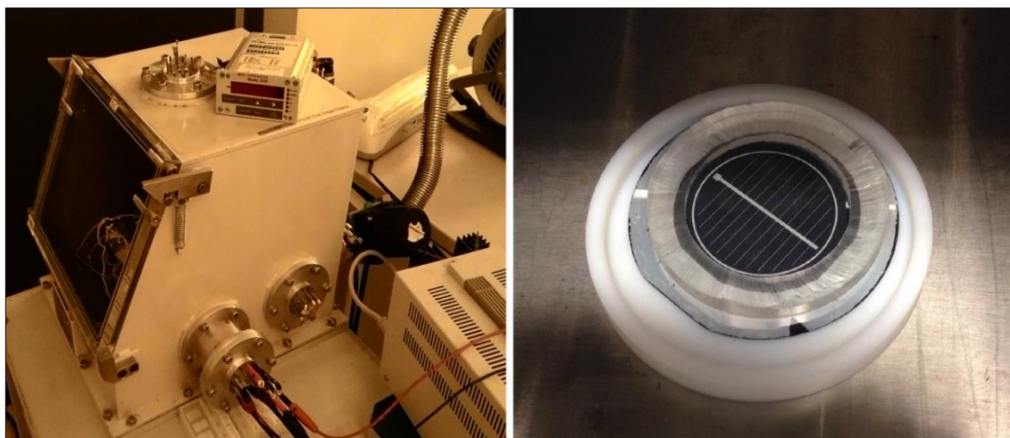
Figura 48 - Dispositivo inserido em uma câmara com pressão de ~70mTorr para evaporação e remoção de solventes que se encontravam na solução aquosa.
