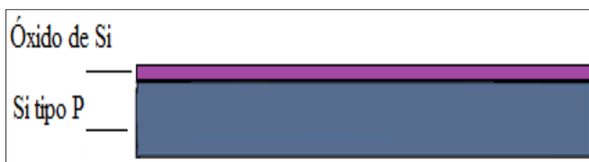
Figura 20 - Lâmina após o processo de oxidação úmida, onde pode-se observar uma fina camada de óxido na superfície.
