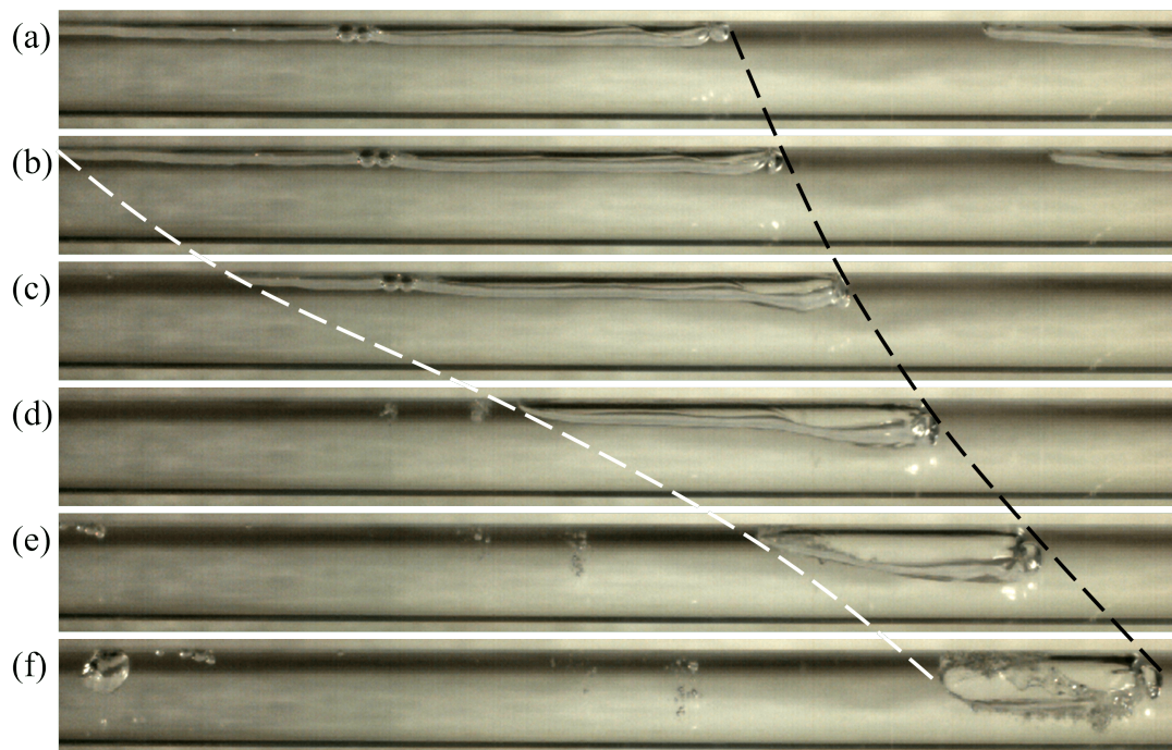
Figura 4.7: Efeito de desaceleração e aceleração no escoamento - Setup B e \sigma = 0,072 , intervalo de 5 frames ou 0,025 segundos entre fotos. Ponto de filmagem: 131 D à montante da placa de orifício.
