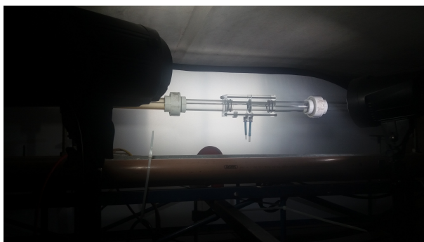
(a) placa de orifício na seção de testes, setup B;
