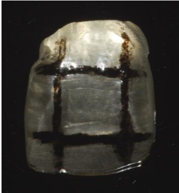
Figura 11: Área de 25 mm 2 demarcada
