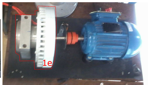
(b) Máquina síncrona de magnetos permanentes e máquina de indução acopladas
