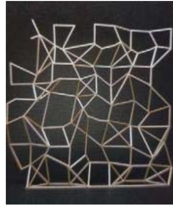
b. Protótipo da camada interna mostrando o giro e a exclusão de barras.
