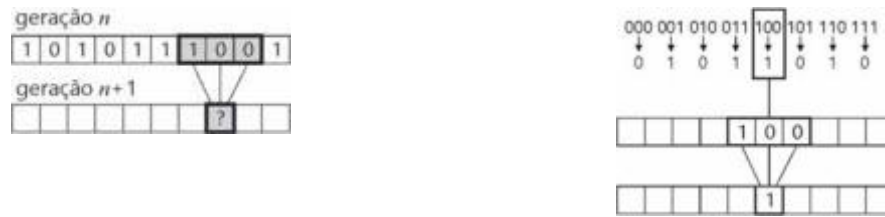
a. Gerações nos instantes de tempo n . b. Vizinhança determinando o novo estado de uma célula.
