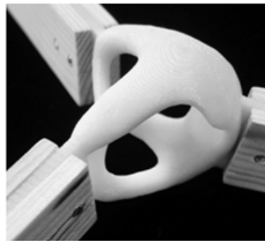
Figura 62: Uma das conexões da pesquisa Smart Nodes. Fonte: O'Donnell (2014).
