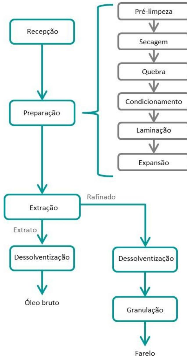
Figura 1. Etapas do processamento de óleo de soja bruto e farelo (Adaptado de Anderson (2005)).
