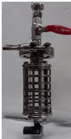
Figura 8. Amostrador para coleta de extrato ao longo do tempo.
