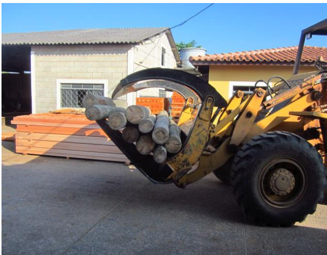
Figura 8 - Pá carregadeira transportando as toras retiradas dos postes para serem desdobradas.
