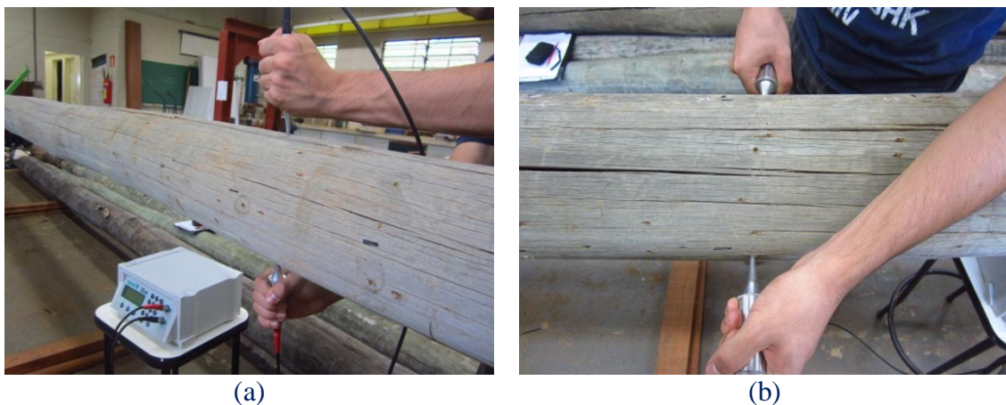
Figura 6 - Ensaio de ultrassom nos postes na posição D1 vertical (a) e D2 horizontal (b).
