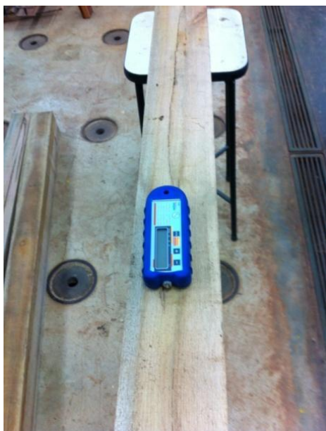
Figura 15 - Medição do teor de umidade da cruzeta.
