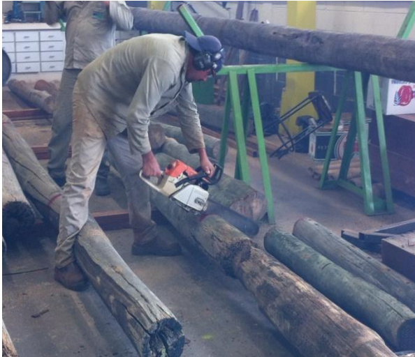
Figura 7 - Corte dos postes para obtenção das toras consideradas em bom estado
