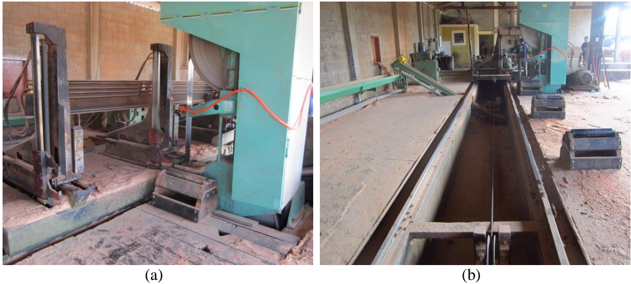
Figura 9 – Serra-de-fita (a) e carro porta-toras (b).
