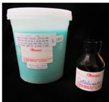
Figura 3- Silicone denso (Silibor-Clássico Artigos Odontológicos) utilizado na moldagem de transferência.
