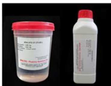
Figura 5- Resina fotoelástica (Araldite, Araltec Produtos Químicos Guarulhos, SP)
