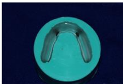
Figura 6 – Molde preenchido com resina fotoelástica.
