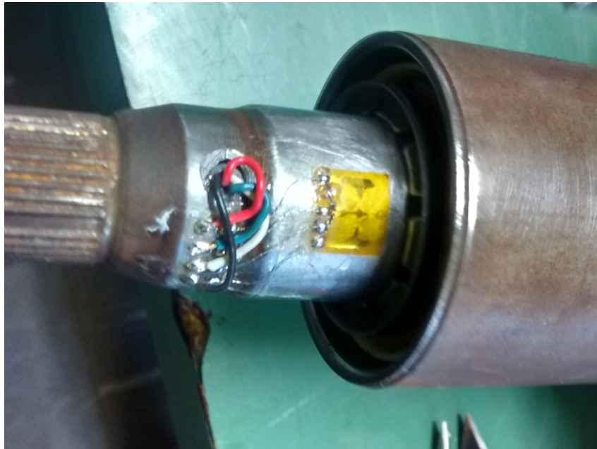
Figura 6.2: Localização do extensômetro no eixo do volante
