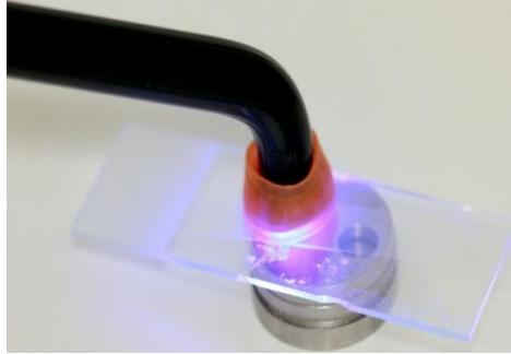
Figura 9- Polimerização da resina composta por cima da lâmina de vidro
