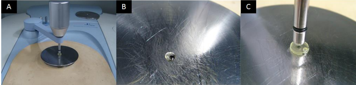
Figura 7. A. Espectroscopia Transformada de Fourier – FTIR. B. análise do material infiltrante não polimerizado. C. análise do material infiltrante polimerizado.
