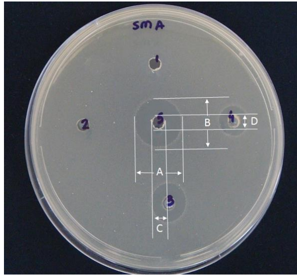
Figura 4. Medida do halo de inibição com paquímetro digital. Cálculo do halo de inibição (mm): [(A+B)/2] - [(D+C)/2] .
