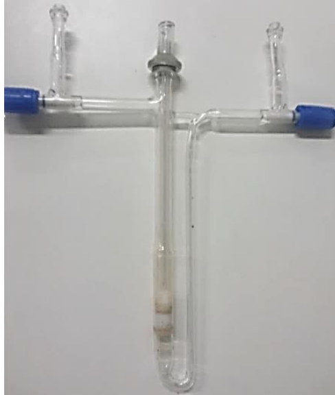
Figura 3.2 - Reator de borossilicato usado nos testes catalíticos.
