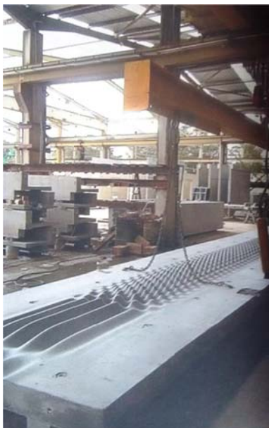
Figura 147. Painel de concreto ornamentado.
