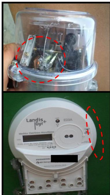
**Fraude:** a capa foi perfurada e o funcionamento do medidor obstruído:
