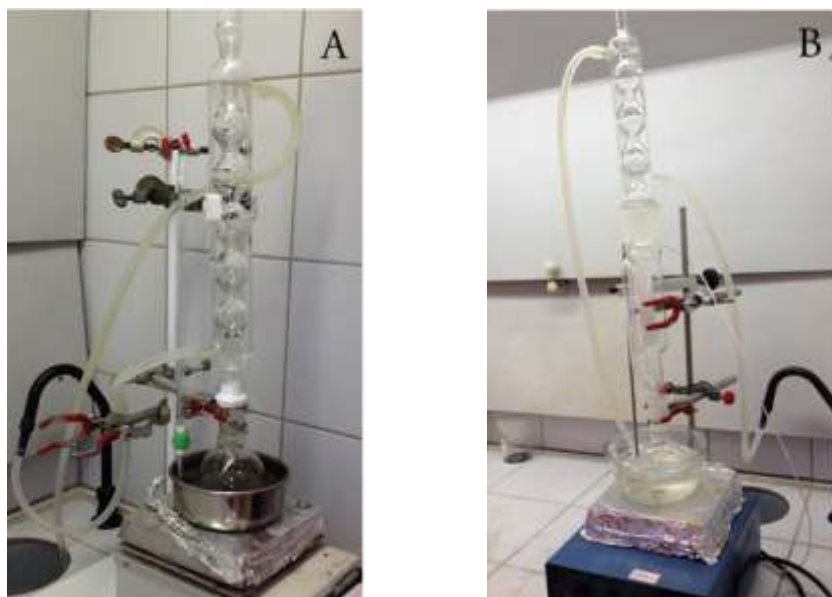
Figura 1 - (A) Sistema de Refluxo com fluxo de água constante; (B) Sistema Soxhlet.
