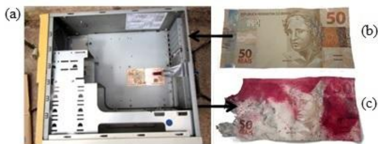
Figura 5. (a) Experimento de simulação de explosão com nota verdadeira (b) antes e (c) após a explosão
