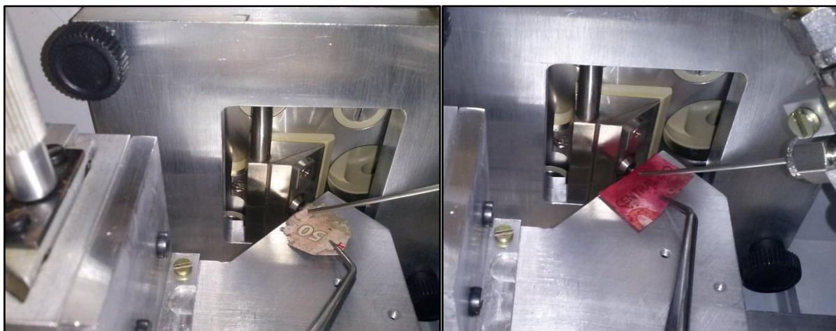
Figura7. Análise de nota após a simulação de explosão (a) em região aparentemente sem tinta antifurto e (b) em região com alta densidade de tinta antifurto
